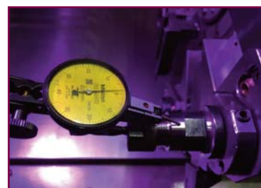
5.완료후 다시한번 보정값을 체크한 후에 가공을 시작한다. Please finally check the RUN-OUT and start the operation
