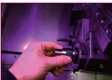
3.동심도 체크후 틀어진 양만큼 터렛의 X축과 GYRO척의 헤드로 돌려가며 원하는 보정값을 맞춘다. adjusting head of GYRO chuck and X of cnc lathe by turning the chuck of cnc lathe
