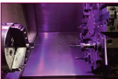
1.터렛에 있는 홀더고정 볼트와 GYRO척 뒤쪽에 있는 볼트를 풀어준다. Please release bolt in turret and bolt in GRYO chuck
